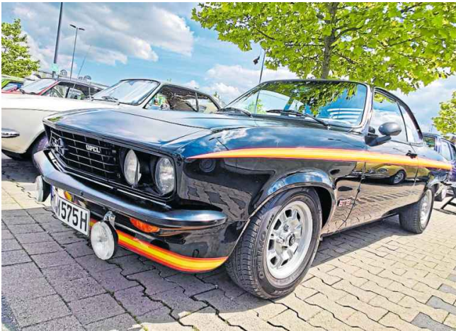
Opel Manta A GT/E „Black Magic“ – Baujahr: 1975 in Antwerpen, Zulassung: 1975, Zylinder: 4-Zylinder-Reihe, Leistung: 105 PS / 77 kW, Motor: 1,9E Bosch L-Jetronic, Leergewicht 980 Kilogramm, Höchstgeschwindigkeit: 188 km/h, Verbrauch: 8,5 Liter auf 100 Km, Restauration: 2008 (1350 Stunden Arbeit), Besonderheiten: Vom Manta A FT/E entstanden 1974-75 etwa 5248 Stück und vom Sondermodell „Black Magic“ zirka 350 Stück. Sonderausstattung: Aluminiumfelgen Fuchs 6Jx13, Anhängerzugvorrichtung, Scheinwerferreinigungsanlage, 5-Gang-ZF-Getriebe, Transistorzündanlage, Dreiklangfanfare, Zusatzscheinwerfer, Nebelschlussleuchte, Intervallschalter, Warnsummer Licht.
