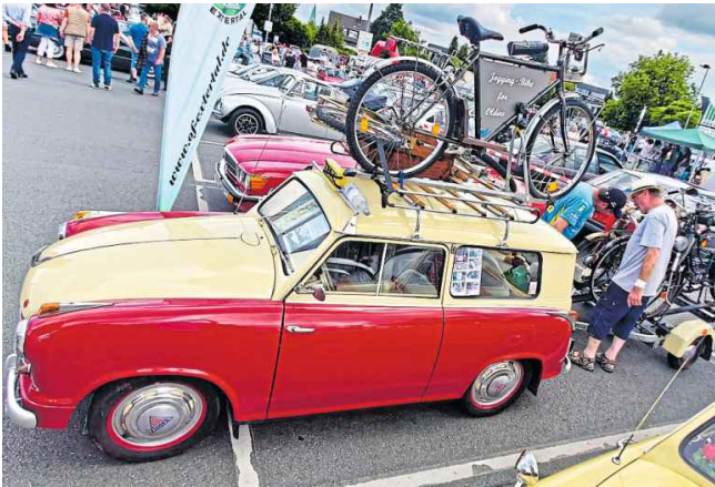
Lloyd LS 400 S – Baujahr: 1956, Hubraum: 400 ccm, Zylinder: 2, Leistung: 13 PS, 3-Gang nicht synchronisiertes Getriebe, Abmeldung: 1976, Restauration 2018-2022, Umbau auf 600 ccm, 2-Zylinder-Viertakt, synchronisiertes Viergang-Getriebe, Bereifung: Diagonalreifen auf Gürtelreifen, Innenausstattung und Innenverkleidung komplett erneuert. Neue zweifarbige Lackierung (von grau/grün auf rot/beige). Umbauten ohne Änderungen an der Karosserie und Bodengruppe. Optische Veränderung: Zusatz-Blinkleuchten und Zusatzscheinwerfer
