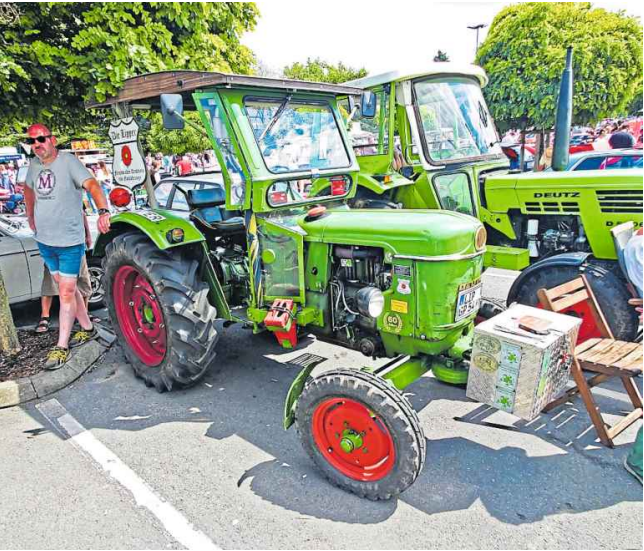
Deutz D25.2 – Baujahr: 1963, Leistung: 20 PS, Hubraum: 1700 ccm, Gesamtgewicht: 2300 Kilogramm
