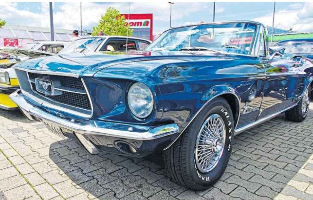
Ford Mustang – Baujahr: 07/1967, Hubraum: 3300 ccm, Drehmoment: 193 Nm, Zylinder: 6er-Reihe, Leistung: 120 PS, Höchstgeschwindigkeit: 160 km/h, Leergewicht: 1250 Kilogramm, Verbrauch: 10-11 Liter auf 100 km, Maße: 4,66m x 1,80m. In der EU seit 2011, gebaute Stückzahl: 70.000, Neupreis 1967: 2600 US-Dollar – mit vorhandener Ausstattung ca. 3000 US-Dollar
