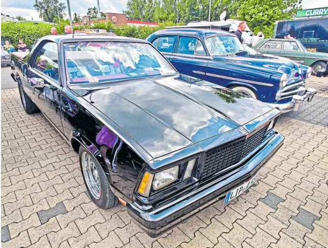
Chevrolet Malibu El-Camino „Black Royal“ – Baujahr: 07/1978 Leistung: 250 PS, Höchstgeschwindigkeit: 200 km/h, Leergewicht: 1600 Kilogramm, Maße: 1810mm x 4850mm, Getriebe: 3-Gang-Automatik
