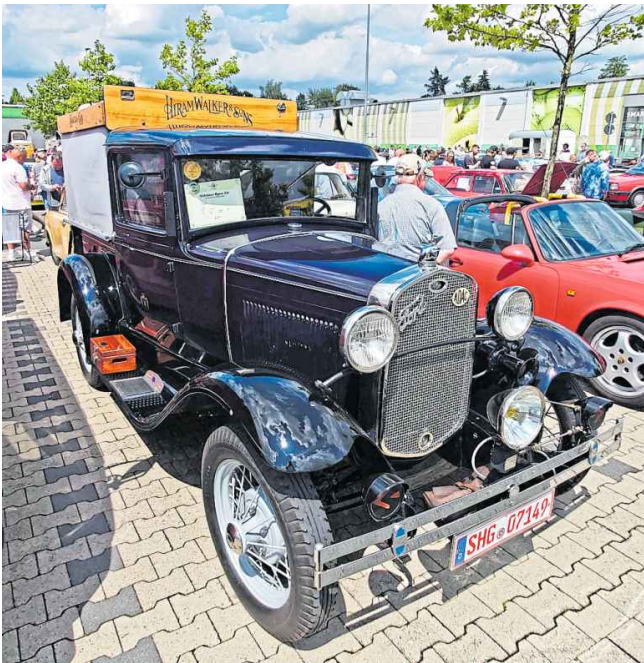
Ford A – Baujahr: 1931, PS: 52, Zylinder: 4, Hubraum: 3,3 Liter, Höchstgeschwindigkeit: 105 km/h. Fotos: Nicole Ellerbrake
