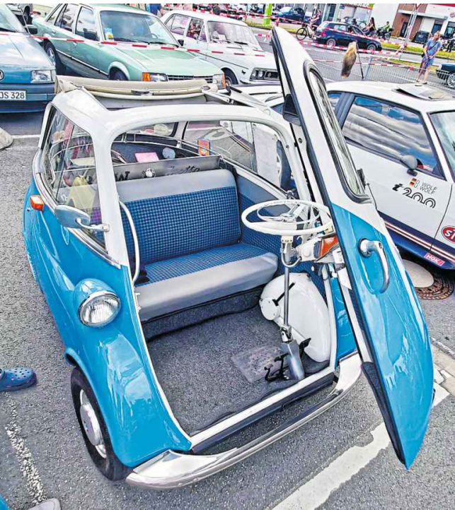
BMW Isetta – Baujahr: 1962, Hubraum: 250 ccm, Zylinder: 1, Leistung: 12 PS, Höchstgeschwindigkeit: 80 km/h. Seit 1987 befindet sich das Fahrzeug im Besitz des Halters, welcher es zwischen 1994 und 1995 restauriert hat. Die simple Bauweise der Isetta wurde zum Erfolg. Zwischen 1955 und 1962 wurden 161.728 Motocoups verkauft. Diese Zahl wurde nur vom Goggomobil der Firma Glas aus Dingolfing übertroffen. Die Isetta gilt heute als Publikumsliebbling und Sympathieträger der Marke BMW sowie als zeithistorisch interessantes Stück Automobilgeschichte. (Oldtimerfreunde Extertal)
