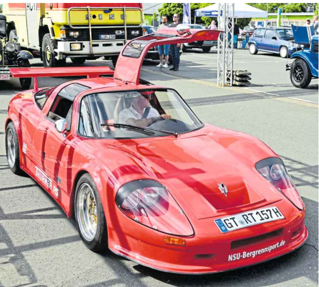
NSU Thurner RS – Baujahr: 1973, Zylinder: 4 (Spiess), Viertaktmotor luftgekühlt, Leistung: 90 PS, Hubraum: 1298 ccm, Antriebsart: Hinterradantrieb, Getriebe: Vier-Gang-Schaltgetriebe, Typ: Coupé Sportwagen, Außenmaße: 3950 x 1570 x 1100mm, Radstand: 2340 mm, Leergewicht: 640 Kilogramm, Radaufhängung: Einzelradaufhängung, Federung: Sportfahrwerk, Höchstgeschwindigkeit: ca. 200 km/h, Kraftstoff: Super-Plus-Benzin, Sonderausstattung: Tiefbettfelgen dreiteilig, BBS, Radio, elektrische Fensterheber, 7 cm tiefer gelegt, Unterboden Edelstahl, Heckspoiler. Besonderheiten: Offiziell wurden 121 Stück gebaut, inoffiziell 89 Stück, bekannt sind noch 47 Stück. Zirka 30 Stück befinden sich auf der Straße.
