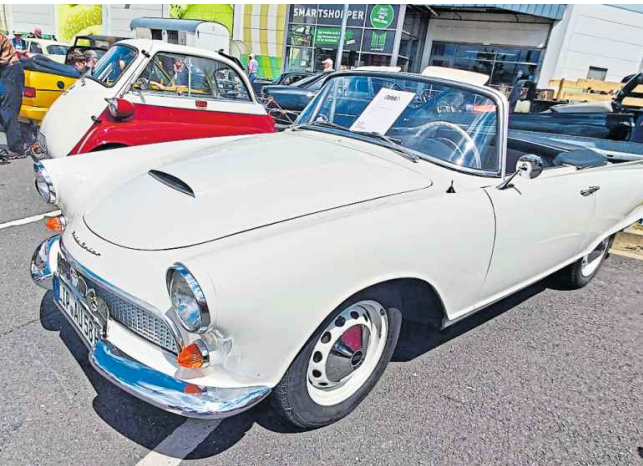
Auto Union 1000 SP Roadster – Baujahr: 1962, Motor: Dreizylinder-Zweitakter, Leistung: 55 PS, Hubraum: 981 ccm, Leergewicht: 680 Kilogramm, Höchstgeschwindigkeit: 140 km/h
