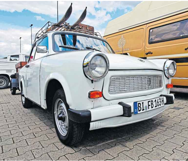
Trabant 601 S – Baujahr: 1988, Zulassungsdatum: 18. Januar 1989, Hubraum: 595 ccm, Motor: 2-Takt, Zylinder: 2, in Reihe, Höchstgeschwindigkeit: 100 km/h, Leistung: 26 PS / 19 kW, Verbrauch: 7-9 Liter auf 100 km, Getriebe: 4-Gang, Revolverschaltung, Frontantrieb, Trommelbremse
